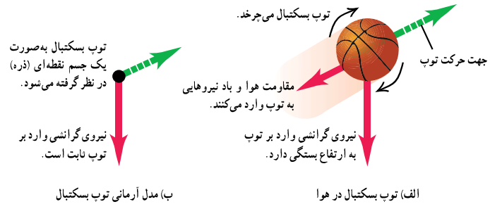
شکل ۳-۱ استفاده از یک مدل آرمانی برای ساده‌سازی تحلیل حرکت یک توپ بسکتبال در هوا
